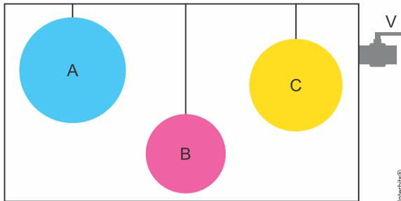
Em seguida, através da válvula V, retira-se grande parte do ar do interior do recipiente. A partir desse instante, predomina um processo de transferência de calor entre os corpos, o que altera os valores de determinada grandeza física.
